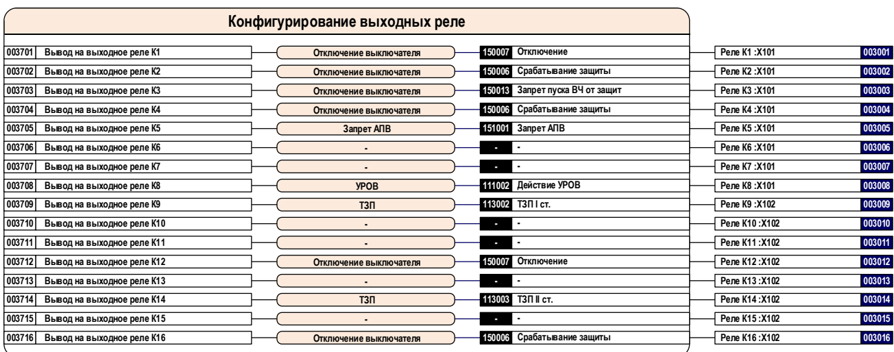
Рисунок 26. Конфигурирование выходных реле терминала
